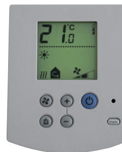
Le boîtier de commande intègre une sonde d'ambiance.
